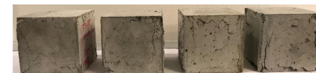
Figur 4: Godkjente brudd på 10 x 10 x 10 cm terninger etter trykktest.
