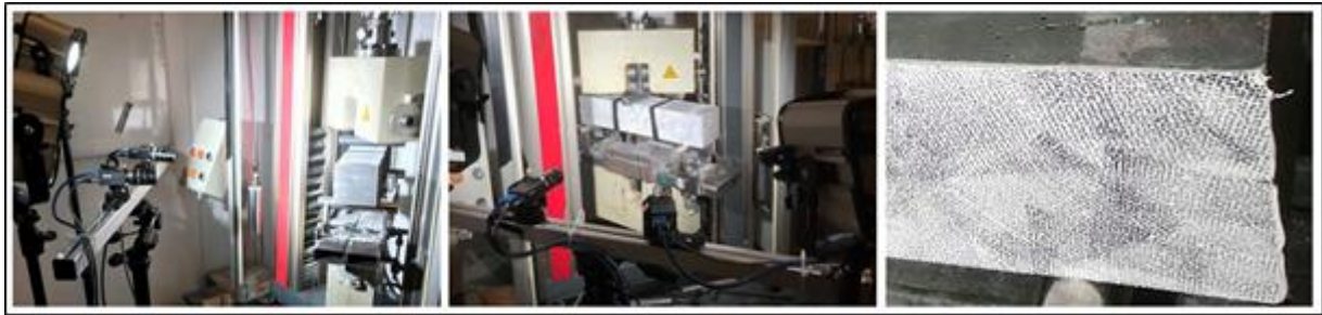
Figur 6-9 Bilde av DIC-kameraet i bruk [Eget bilde]
