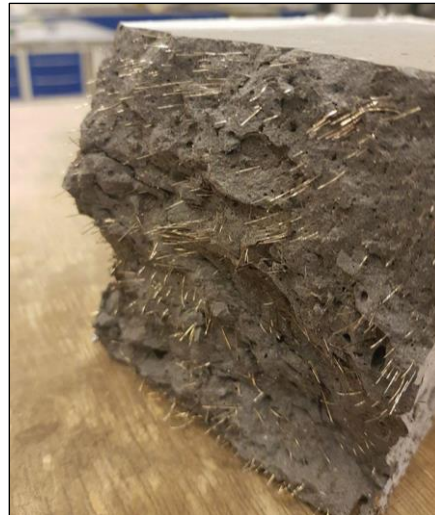
Figur 8-1 Bruddflaten til en prisme etter testing [Eget bilde].
