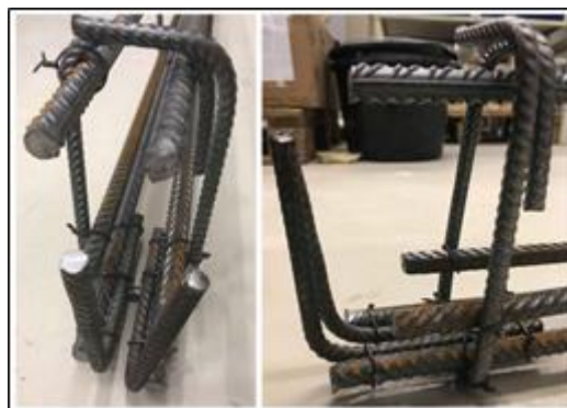
Figur 7-3 Bilde av forankringsarmering [Eget bilde]
