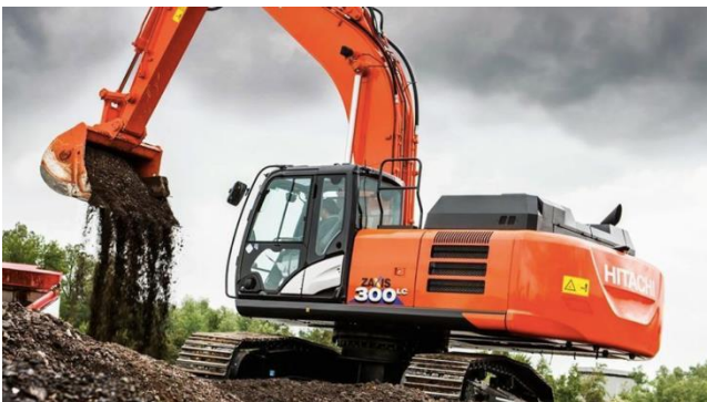
Figur 11 - Elektrisk gravemaskin fra Hitachi [123].
