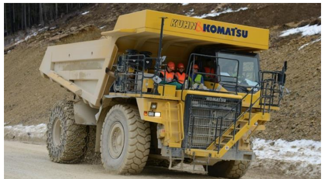
Figur 12 -Dumperen som skal elektrifiseres fra Komatsu [41].
